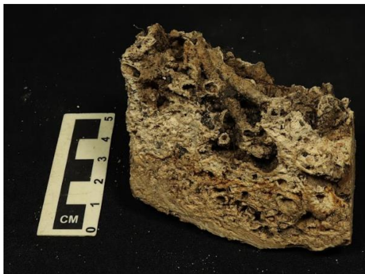
Figura 11. Tufa calcária Fitohermal, da Muralha do Rio Formoso, Bonito-MS, destaque para abundância de fragmentos vegetais como troncos e folhas com camada fina de micrita no topo da amostra, Amostra 11-FOR-02.
