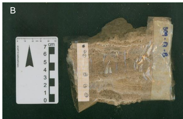
Figura 26. Amostras MM-01 (26.A) e 02 (26.B), moss/sinter tufa clássico provenientes do Rio Mimoso.
